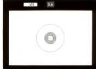
シャッタースピードは、マニュアル露出時と同様に、絞り値の左横に液晶でデジタル表示されます。シャッタースピード表示は8秒～1/2000秒まで15段階。オート露出の場合、実際のシャッタースピードは、8秒～1/2000秒の間で電子制御により、ほぼ無段階に得られますが、露出表示は見やすいデジタル表示とするため、最も近い数値のシャッタースピードを表示します。この他、高速・低速側のシャッタースピード運動範囲露出警告も表示します。
